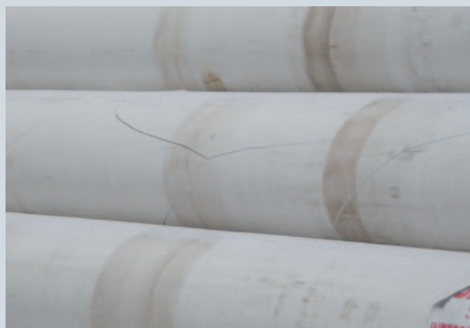
Bild 4 und Bild 5: Schaden an einer PP-Umhüllung durch Kälteversprödung nach einem Rohreinzug und auf dem Rohrlager
