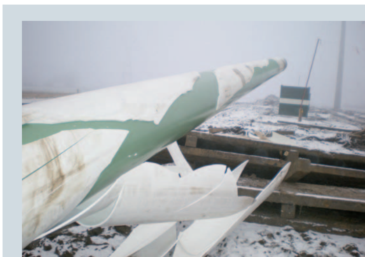
Bild 4 und Bild 5: Schaden an einer PP-Umhüllung durch Kälteversprödung nach einem Rohreinzug und auf dem Rohrlager
