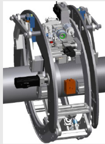
Bild 7: Automatisiertes Laserstrahlschweißen mit Dokumentation der Schweißnahtprüfung
