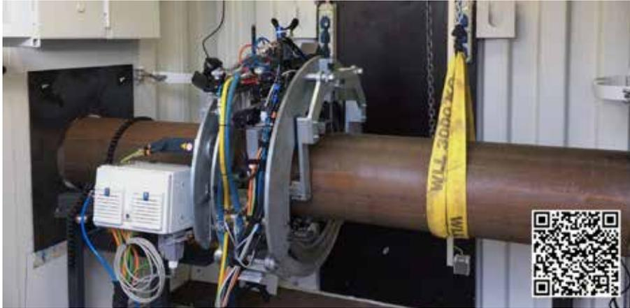
Bild 2 • Schweißen mit der Laserstrahl-Orbitalschweißzange (der QR-Code sowie der nachfolgende Link führen zu einem Video mit der Demonstration des Schweißprozesses: [https://www.slv-halle.de/fileadmin/user\\_upload/Halle/Videos/IRO/2020-02-14\\_IRO.mp4](https://www.slv-halle.de/fileadmin/user_upload/Halle/Videos/IRO/2020-02-14_IRO.mp4)).
