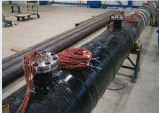
**Bild 11:** Baueinheiten der Versuchsleitung mit integrierten Temperatursensoren
