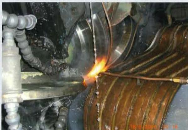
**Bild 1:** Rohrproduktion mittels HFI-Schweißprozess
