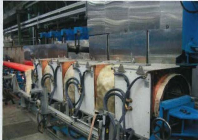
**Bild 3:** Rohr während des Anlassens
