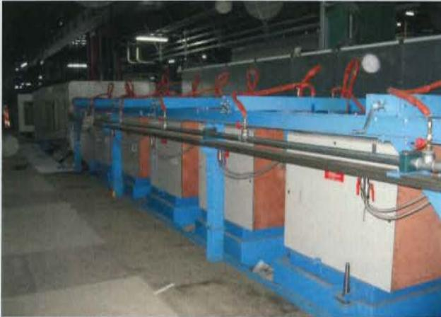
**Bild 2:** Induktionsspulen für die Austenitisierung
