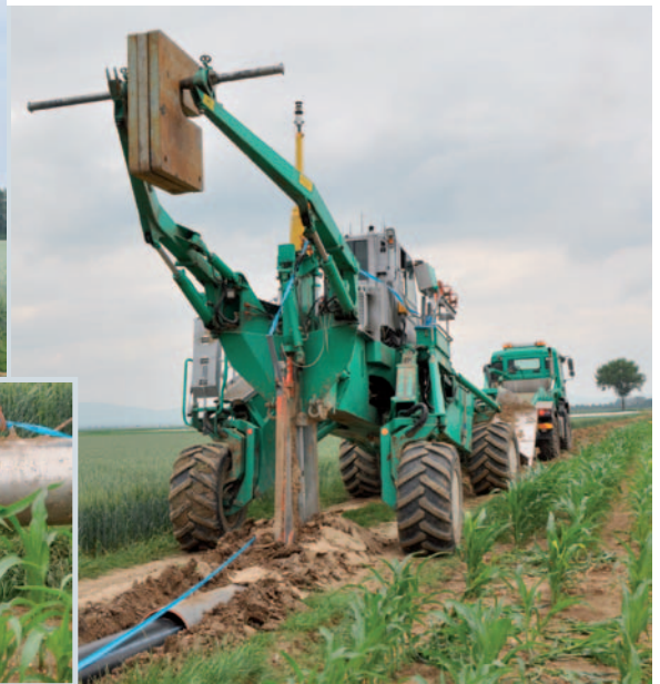
Pflügen des Rohrstranges
