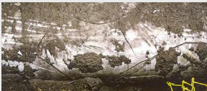
**Bild 5 und Bild 6:** Rissbildung von PE-Umhüllungen durch Materialversprödung
