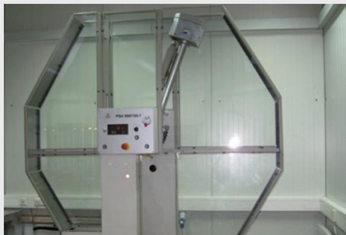
**Bild 3** und **Bild 4:** Ermittlung der Kerbschlagzähigkeit des Rohrmaterials
