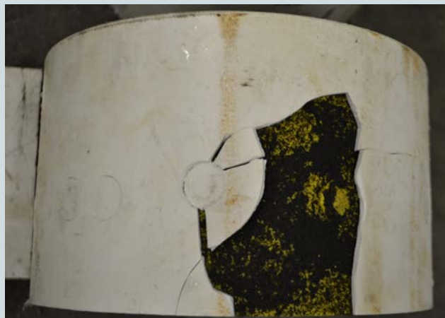
Bild 11: Ergebnis der Schlagprüfung
