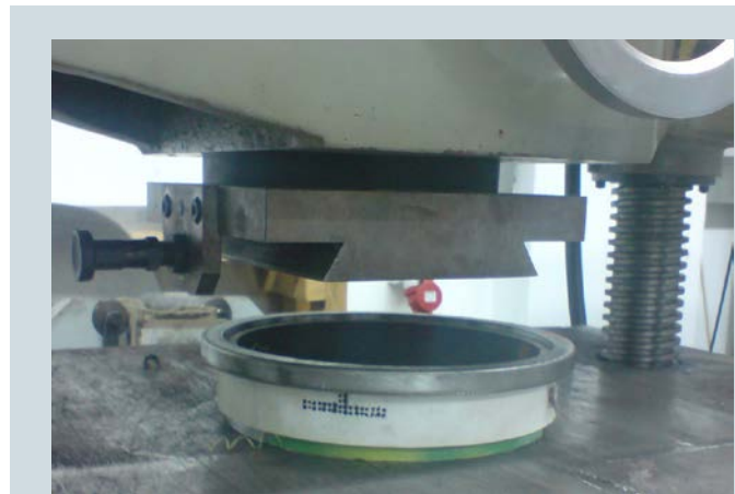
Bild 7: Aufbau zur Prüfung der Scherfestigkeit
