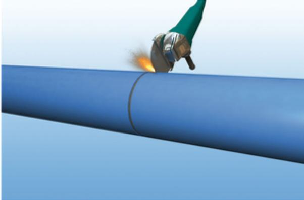
1. Trennen des Rohres mittels Trennschleifer. Es können Trennschleifer mit Benzinmotor, Elektro- oder Pressluftantrieb verwendet werden. Es empfiehlt sich, Trennscheiben für Stahl des Typs A 24 einzusetzen.
