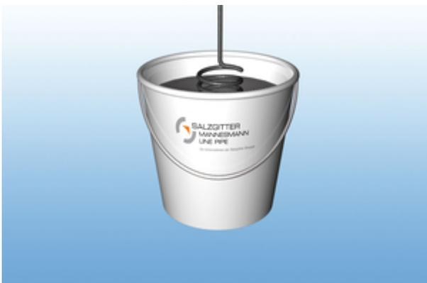
4. Wasserbehälter dem Gebinde entnehmen, den Trockenmörtel kurz aufrühren, dann das Wasser in den Mörtel geben und anrühren. Mit Rührvorsatz klumpenfrei homogen verrühren.
